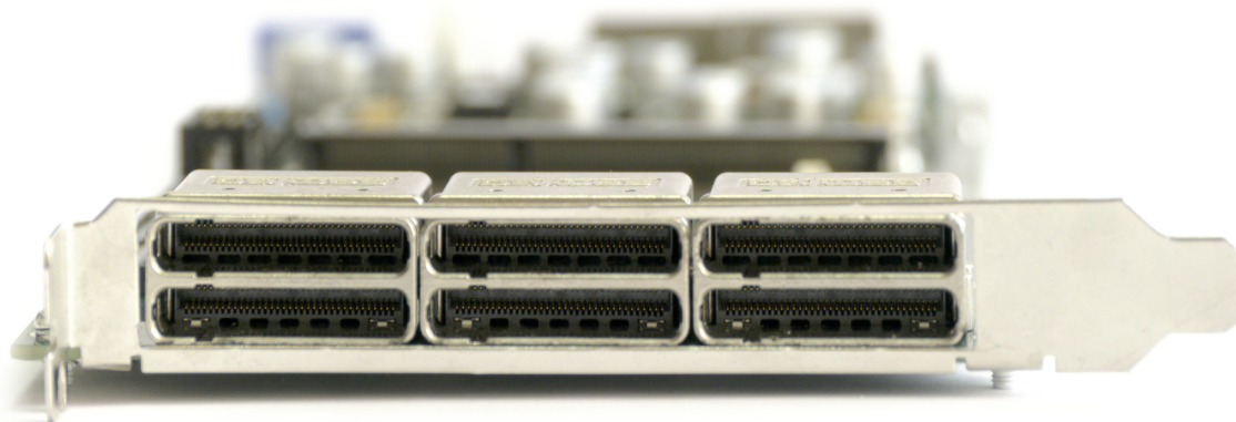
Рисунок 3. Сетевой адаптер «Ангара» на базе СБИС ЕС8430, разъёмы SAMTEC
